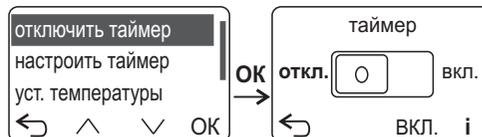
Выберите пункт «отключить таймер», если хотите перейти в режим **Ручное управление**. Терморегулятор будет постоянно поддерживать одну заданную температуру.
