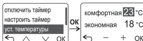
В пункте «**установка температуры**» задайте комфортную и экономную температуры. Кнопка «OK» для внесения изменений и перехода по меню. Для выхода нажмите «←».
