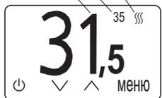
Нажмите и удерживайте левую кнопку в течение 5 с. После отключения терморегулятор перейдет в спящий режим. Для полного отключения выньте терморегулятор из розетки или отключите автоматический выключатель в щитке при длительном перерыве в использовании.
