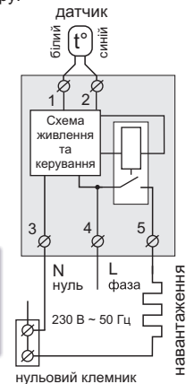
Схема 1. Спрощена внутрішня схема і схема підключення
