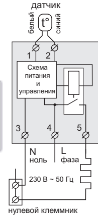
Схема 1. Упрощенная внутренняя схема и схема подключения
