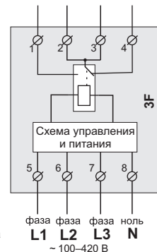
Схема 1. Упрощенная внутренняя схема и схема подключения
